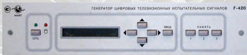
Вид генератора Г-420 со стороны лицевой панели
