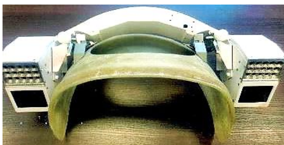
Моноблок телекамеры–осветители–передатчик, его разработчик А. В. Галахов и использование моноблока в составе скафандра при внекорабельной деятельности космонавта
