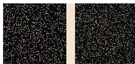
Два соседних темновых кадра с помехами (точечные и треки) из-за облучения протонами
