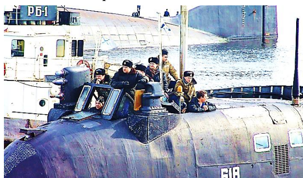
Комплекс МНК-200-1 «Тукан», на переднем плане забортное устройство оптико-телевизионного канала, в которое входит аппаратура «Пиранья»
