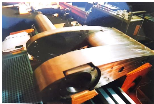
Оптико-телевизионная аппаратура, забортное устройство для АПЛ в титановом корпусе; конструктор Е. В. Письменный. 2007 г.
