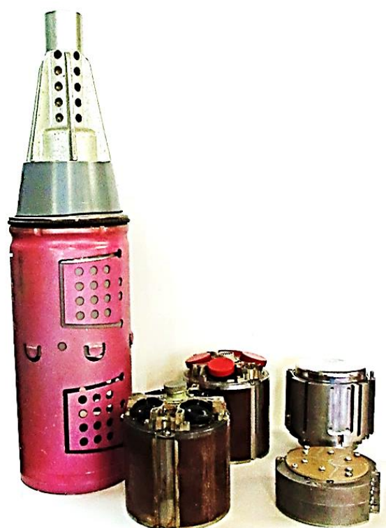
Аппаратура «Удилище»; снаряд, камерные головки, передатчик, источник электропитания; конструкторы Ю. В. Троицкий, С. П. Платонов, Н. А. Балакирев. 1986 г.
