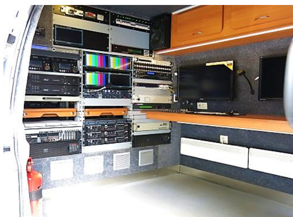
Размещение технологического оборудования в рабочем отсеке станции
