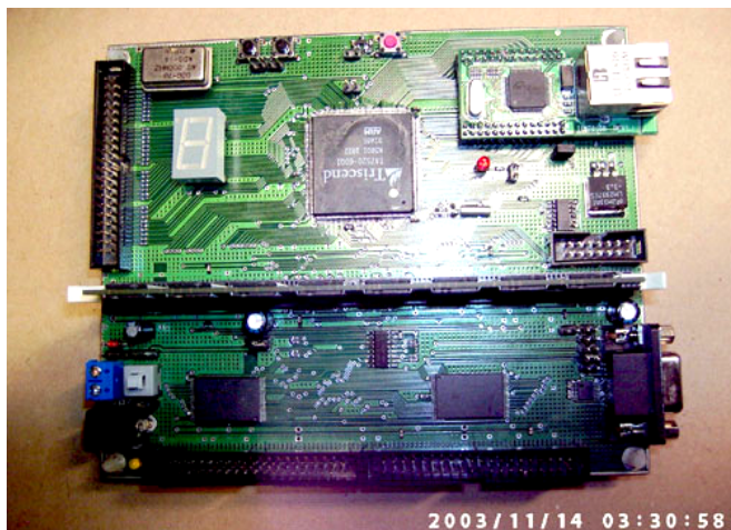
Рис. 4.11. Устройство ввода и обработки видеoinформации на основе технологии система на кристалле
