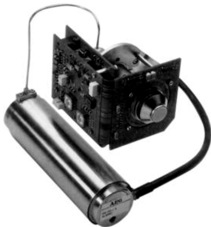
Рис. 1.37. Приёмный криогенно охлаждаемый модуль ИК твердотельной телекамеры
