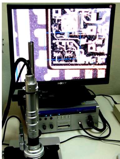
Рис. 4.2. Телевизионно-компьютерная система контроля СБИС
