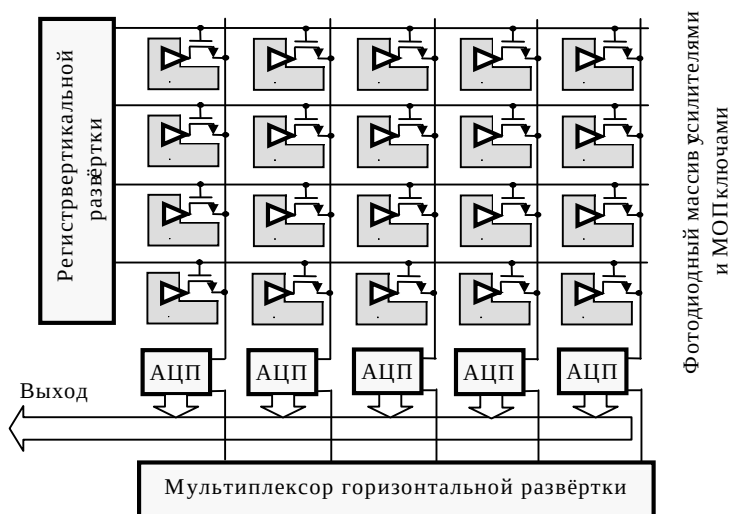
Рис. 1.20. КМОП сенсор с активным пикселом и АЦП на каждый столбец
