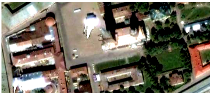
Рис. 1. 15. Пример изображения с типичным искажением растекания зарядов из-за локальной пересветки
