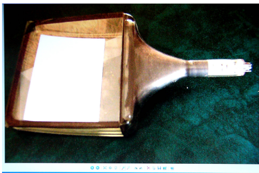
Рис. В.3. Изображение кинескопа с электронной пушкой, почти параллельной экрану, на экране жидкокристаллического монитора
