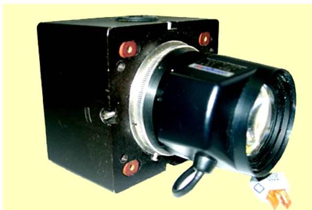
Рис. 1.10. Телекамера для морских применений; матрицы ПЗС класса \frac{1}{2} " фирмы Sony
