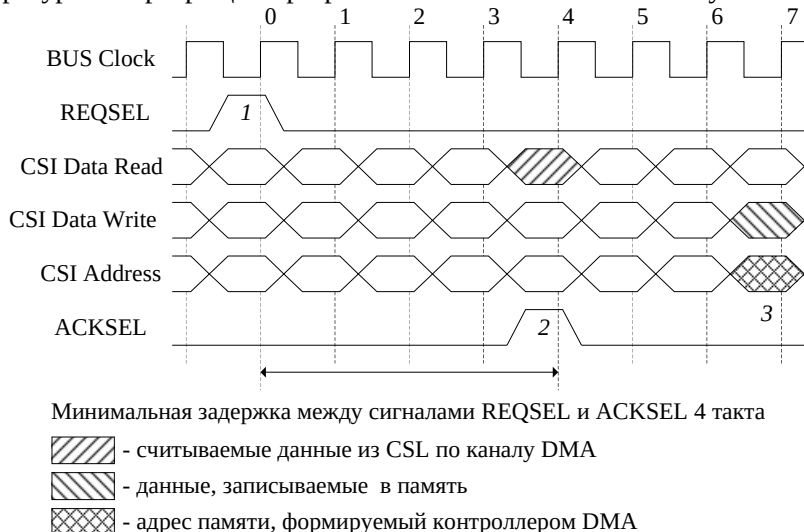
Рис. 4.9. Временная диаграмма записи в память
