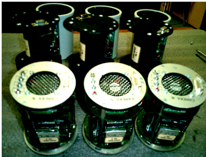
Рис. 1.9. Астрономические телекамеры на охлаждаемых с помощью термоэлектрических холодильников матричных ПЗС, предназначенные для использования совместно с ЭОП в составе астрономического многоканального телевизионно-компьютерного комплекса) [123]; матрицы ПЗС класса \frac{1}{2} " фирмы Sony
