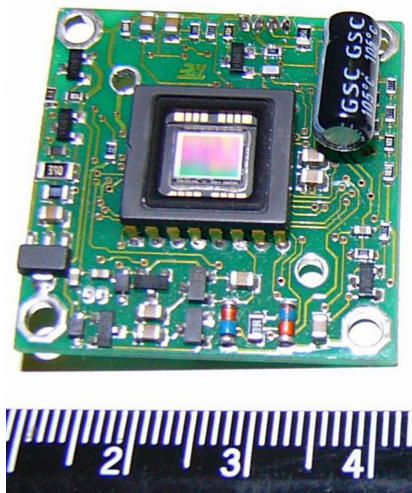
Рис. 1.13. Одноплатная бескорпусная телекамера на матричном ПЗС класса 1/3" фирмы Sony
