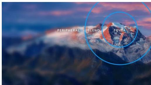
Рисунок 55 – Чёткость изображения монитора с динамическим фовеальным рендерингом (DFR) при отслеживании взгляда пользователя; выделены три зоны, соответствующие зонам сетчатки глаз: фовеальная, средняя и периферийная
